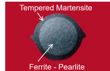
Anneal tempered martensite layer
